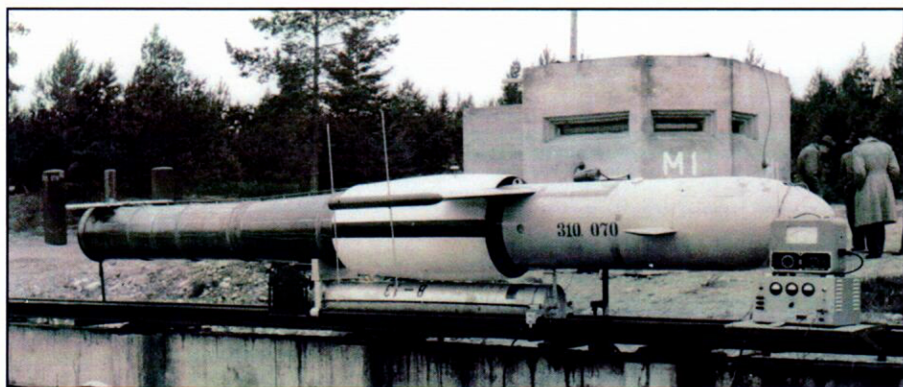
unten: Insgesamt nur zehn Baumuster wurden von der insbesondere auf Leistungsverbesserungen zielenden mit Pfeilflügeln ausgestatteten Entwicklung Rb.311 erprobt.
