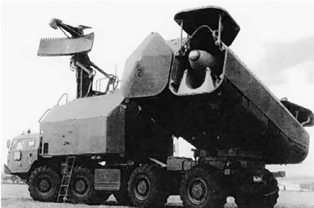
Eine Selbstfahrende Startrampe des KRR-18 in der Startstellung klar zum Start der Raketen (PG)
