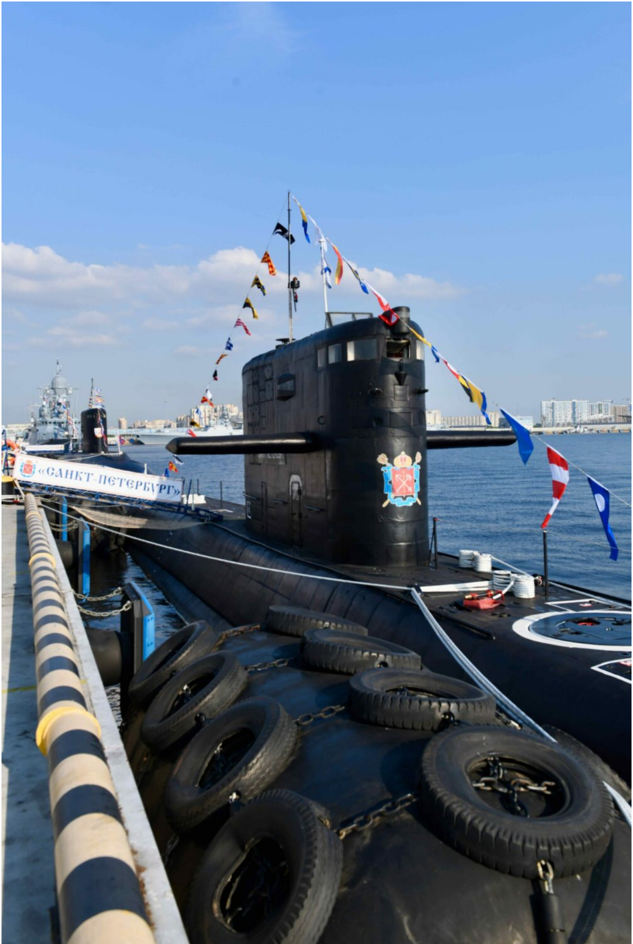
Das konventionelle U-Boot "St. Petersburg" von Projekt 677 ist das neueste nicht atomgetriebene U-Boot-Design. Foto: Yuri Laskin
